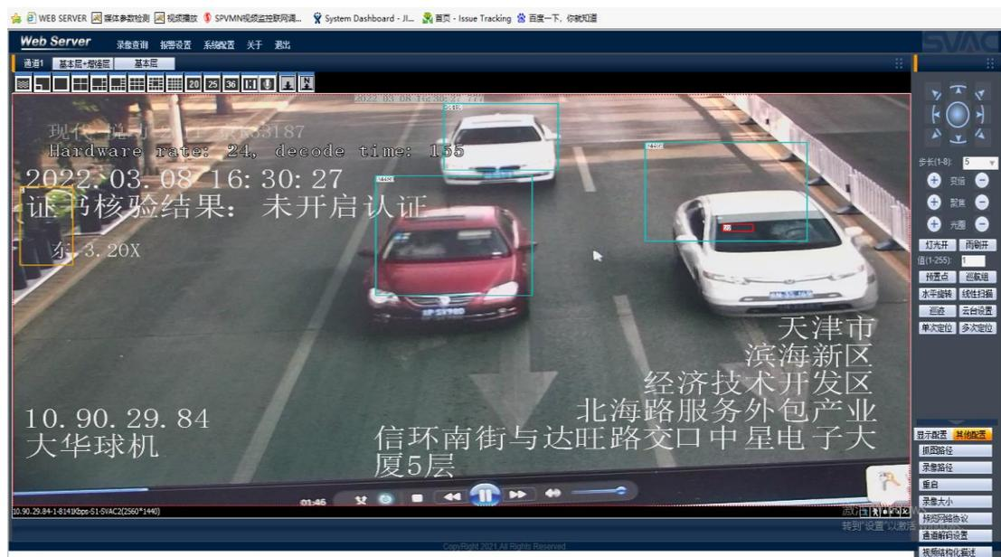
图 112 视频结构化画面显示机动车蓝色框
