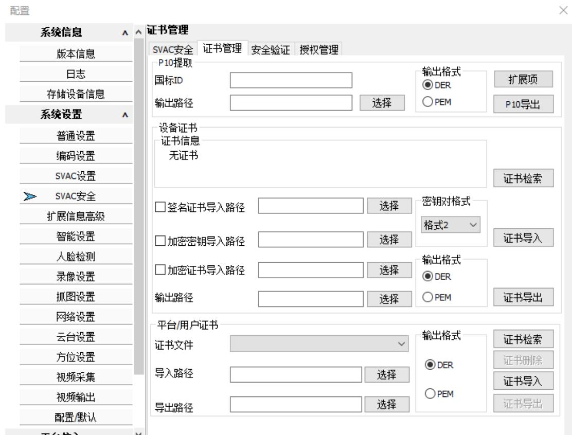
根据设备型号，密钥对格式主要有格式 2、格式 5、RAW 和 P7B。
