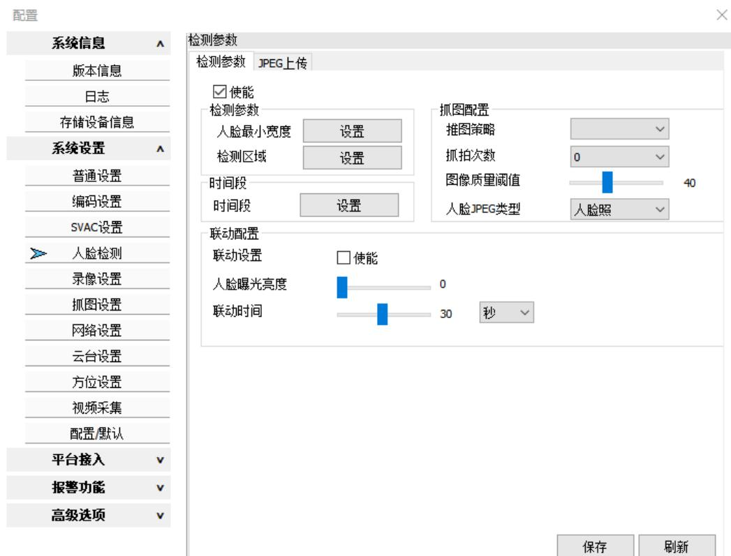
在此页面可以设置人脸检测参数和 JPEG 上传。人脸检测参数包含 参数使能、最小宽度、检测区域、抓图策略、抓拍次数、抓图质量阈值、检测时间段设置、人脸属性分析、检测报警联动、人脸曝光亮度、联动时间设置和联动配置。其中联动配置根据能力集区分为普通联动和场景 AE 亮度联动普通联动包含联动使能人脸曝光亮度调节和联动时间设置。场景 AE 亮度联动配置如下图所示。
