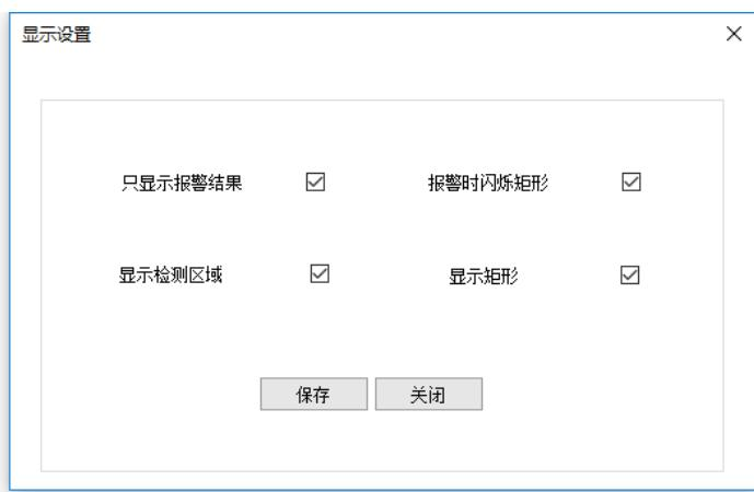
勾选“只显示报警结果”，只显示触发入侵/越界/逆行报警的运动物体信息，如：在勾选“显示矩形”的前提下，只显示触发报警的物体外接矩形；
