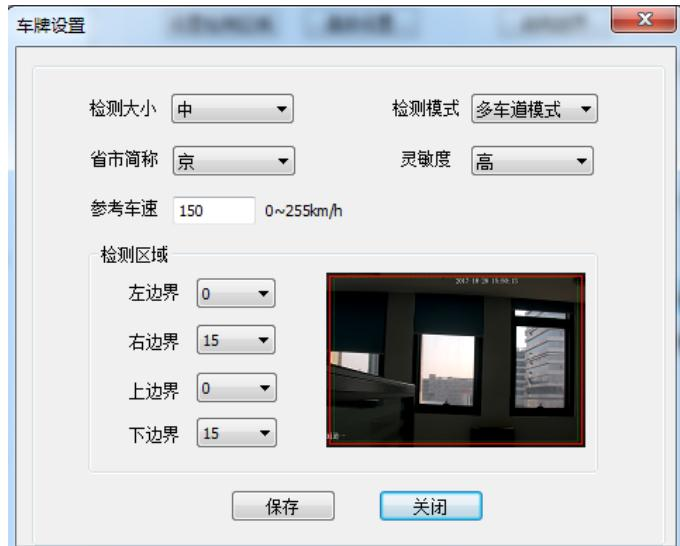
“检测大小”：设置“小”、“中”、“大”，指在进行车牌检测时，检测车牌的大小需求。“小”指镜头中的车牌尺寸的宽为 30~150 像素范围，“中”指车牌尺寸的宽为 40~200 像素范围，“大”指需要车牌尺寸的宽为 60~300 像素范围。
