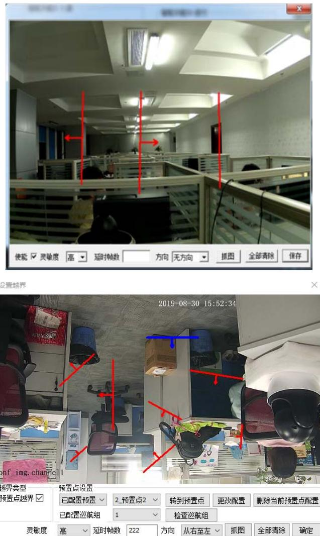
用户绘制越界线段，并对越界线段进行使能、灵敏度、延时帧数、方向设置。
