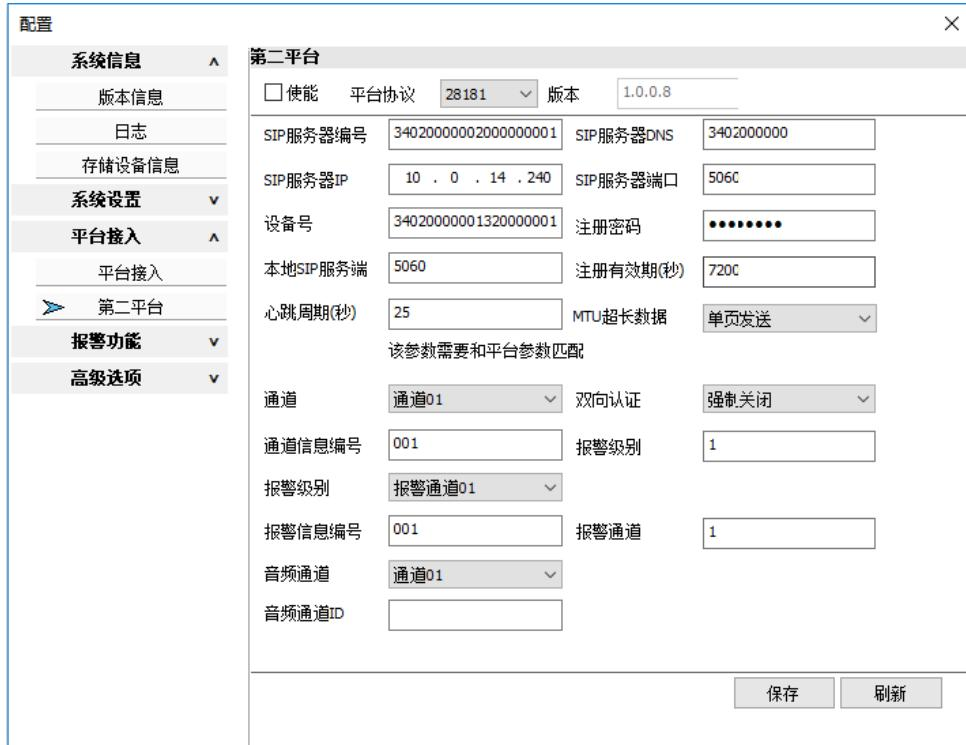
此 28181 和 “平台接入” 中的 28181 项不能同时使用，设置完成后需要设置高级平台配置中的第一项“高级平台配置”中相应参数。第一项“高级平台配置”如下图 2:
