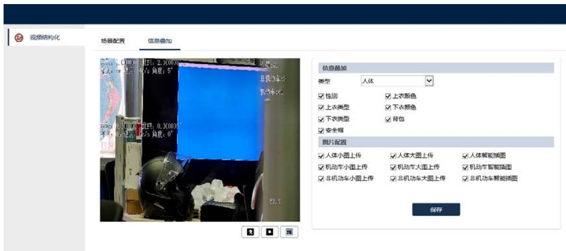
信息叠加：设置结构化信息的叠加内容。结构化信息会叠加到 SVAC 码流中。
