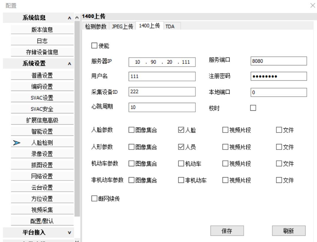
1400 协议包括是否使能、服务器 IP、服务端口、用户名、注册密码、采集设备 ID、本地端口、心跳周期、校时、断网续传以及人脸参数和车牌参数等信息。人脸参数和车牌参数有包括大图、小图视频和文件四个选项。
