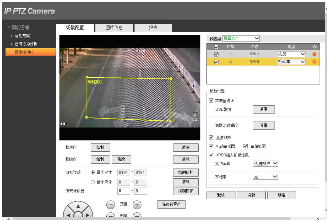
注：检测区和排除区对同一个预置点的不同规则均起作用，不能单独为某种规则配置不同检测区和排除区（修改后同一预置点下的其他规则检测区和排查去也会被修改）。
