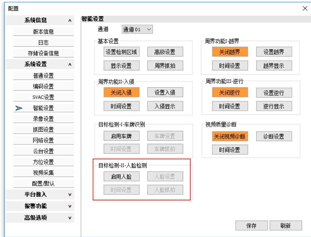
(1) 选择<启用人脸>标签，人脸检测功能开启，<人脸设置>和<时间设置>使能，用户方才可进行人脸检测功能的配置；在人脸检测功能开启的前提下，再次点击“启用人脸”，人脸检测功能关闭。
